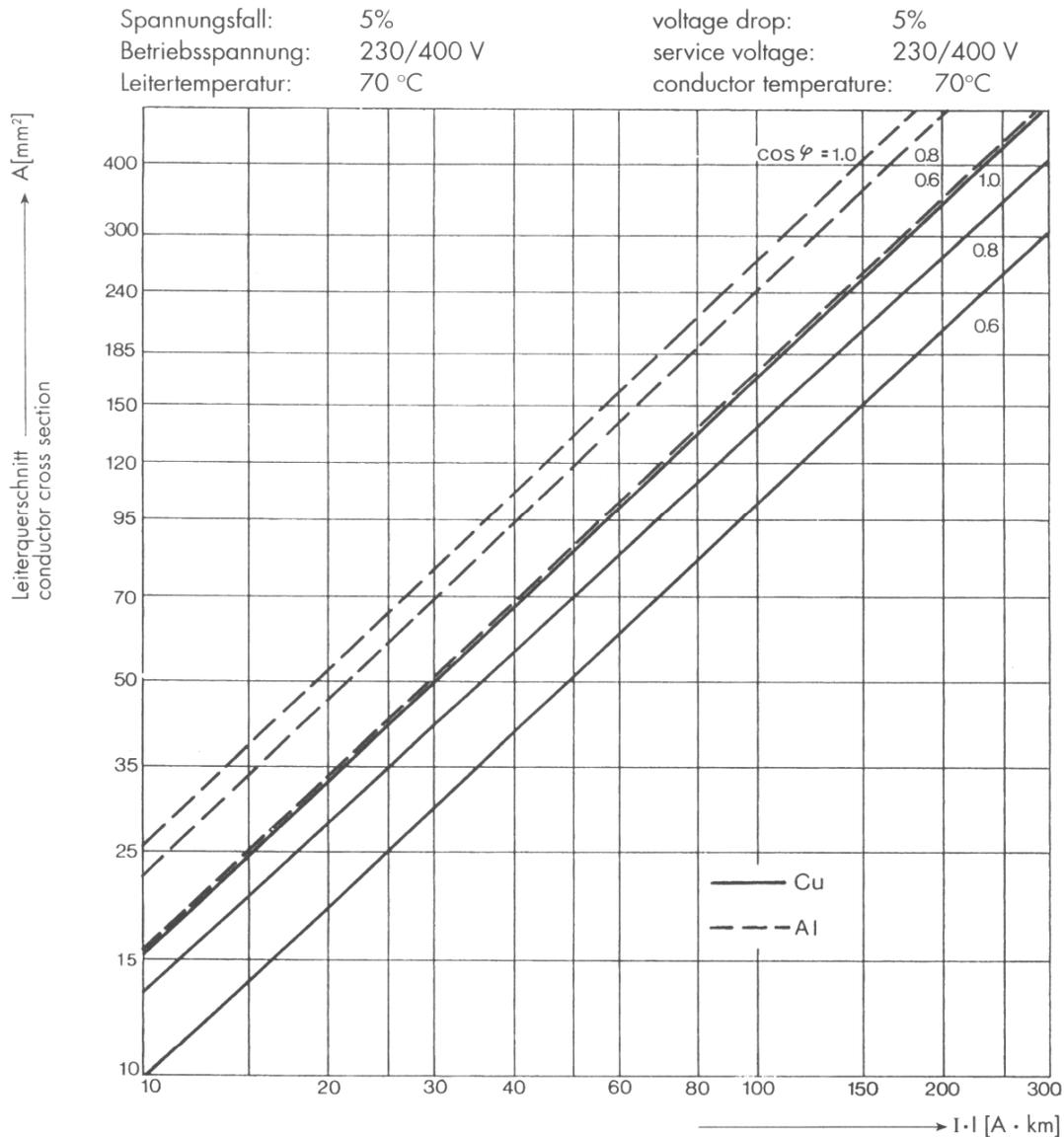
In vielen Fällen, vor allem bei großen Querschnitten, muss neben dem ohmschen auch der induktive Spannungsfall berücksichtigt werden.
